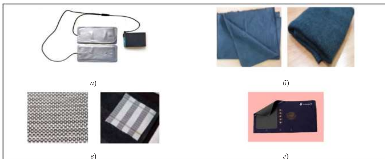
Рис. 5. Виды нагревательных элементов для одежды: а) – на основе пластин с углеродной пастой;
