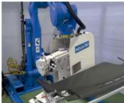
Рис. 6. Швейная машина, установленная на робот-манипулятор
