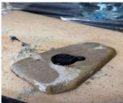
1. Галька с мазутом после извлечения из солёной воды (18 г/л) при 16 °С
