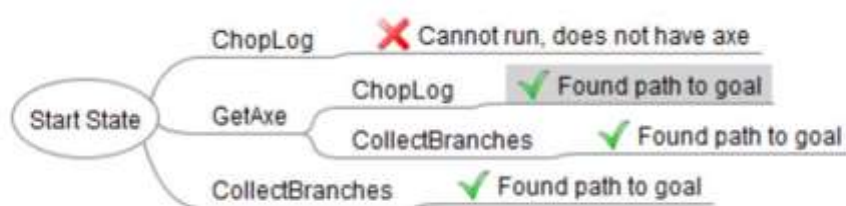
2. Дерево, построенное планировщиком GOAP, на основе алгоритма рубки дерева.
