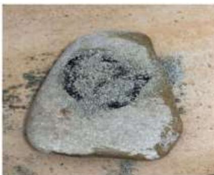
2. Галька с мазутом после извлечения из соленой воды (18г/л) при 16 °С и нанесения сорбента
