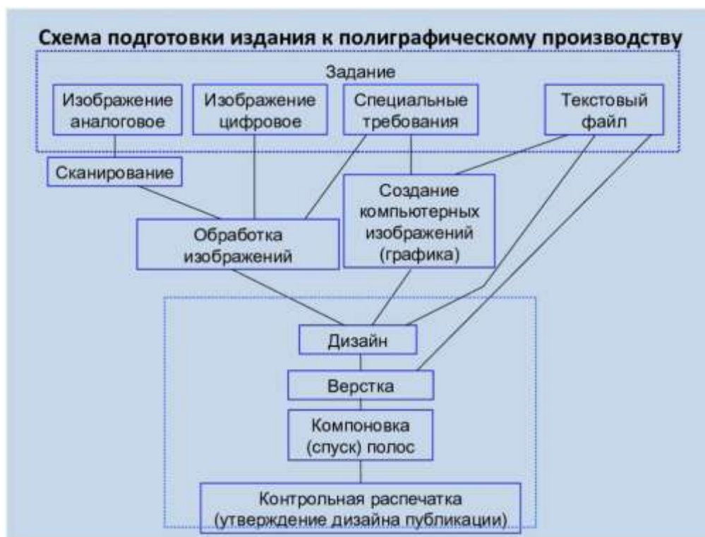
1 Схема подготовки издания к полиграфическому производству
