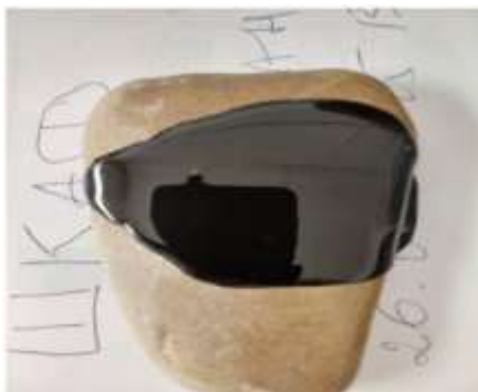
4 Галька с нанесенным мазутом при температуре 75°С
