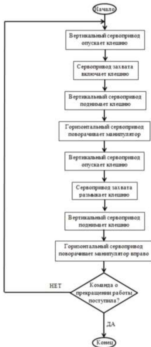
Рисунок 6 – Схема алгоритма работы манипулятора
