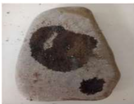
6. Галька после удаления сорбента при температуре 75°C
