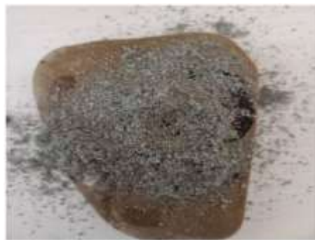
5. Галька с нанесенным сорбентом при температуре 75°C
