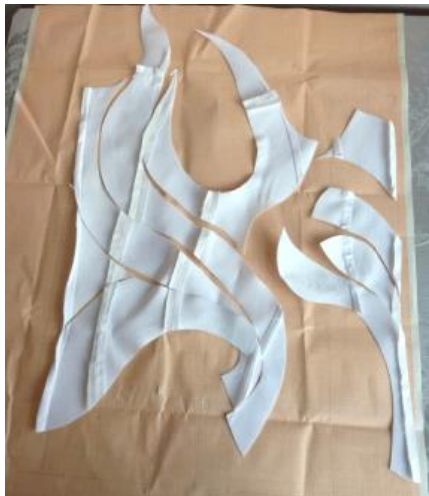
Рис.3. Процесс разрезания формообразующих деталей до плосколежащих
